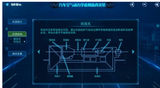
图 17 回流式风洞结构
