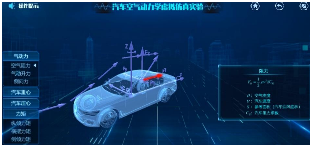
图 15 汽车气动六分力
